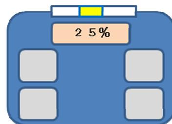
まず、電気抵抗ですが、中学の理科に出てきそうな、筋肉は電気を通しやすいが、脂肪はほとんど通さない、という原理により、通電して見て、筋肉質な人は電気抵抗値が小さく、脂肪の多い人は抵抗が大きくなります。また、電気抵抗は距離が長いほど大きくなるので、身長をインプットすることによって、例えば、両手の間隔とか、右手と左足の距離などを推定して調整します。
